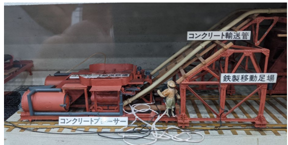
コンクリートプレーサーのイメージ (資料提供：西日本高速道路(株))
