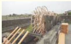
⑫ 三連水車 堀川用水が引かれたあとも、水を田畑に上げることができない地域で、水を引き上げる自動回転の水車が発明された。
